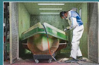
▲ Le technicien déglace le pont en vue du collage sur la coque. Attention à ne pas abîmer le moule.
