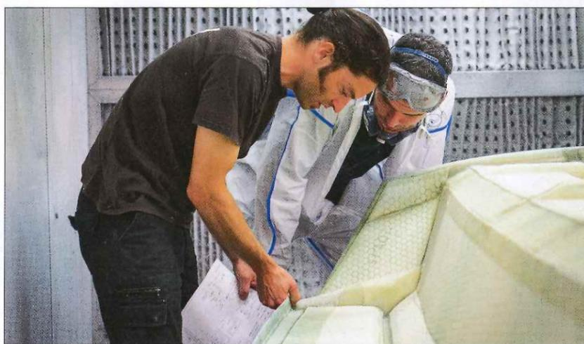
▲ Au niveau de ce guide d'échelle arrière, on a une grosse épaisseur de tissu. C'est le genre de zone qui peut poser des problèmes d'ajustement au moment de « fermer la boîte ». Il faut la vérifier.
