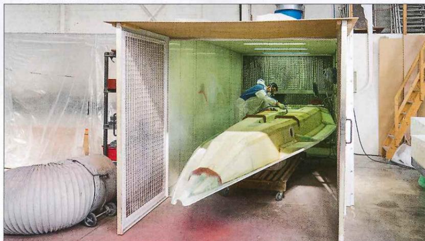
▲ Dans la cabine de ponçage, le pont fraîchement infusé est déglacé et ajusté à la coque si nécessaire. C'est souvent le cas sur les premières unités d'une série.
