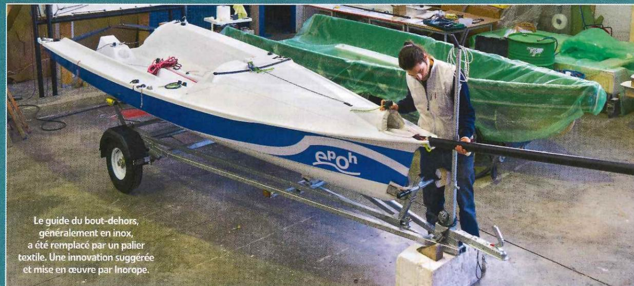
Le guide du bout-dehors, généralement en inox, a été remplacé par un palier textile. Une innovation suggérée et mise en œuvre par Inorope.
